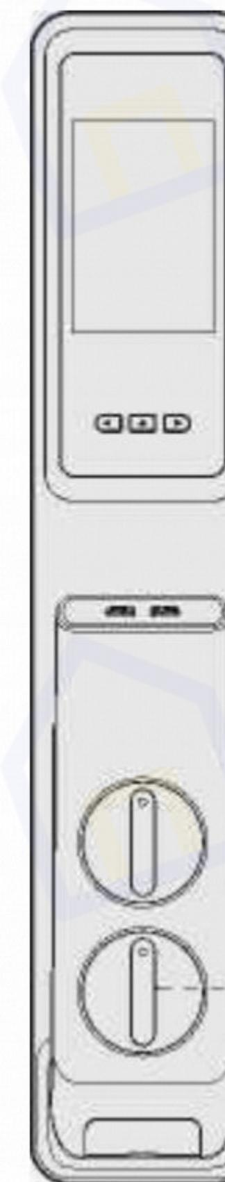
Поверните засов в положение блокировки, чтобы заблокировать замок вручную. Таким образом замок нельзя разблокировать снаружи, только изнутри.
